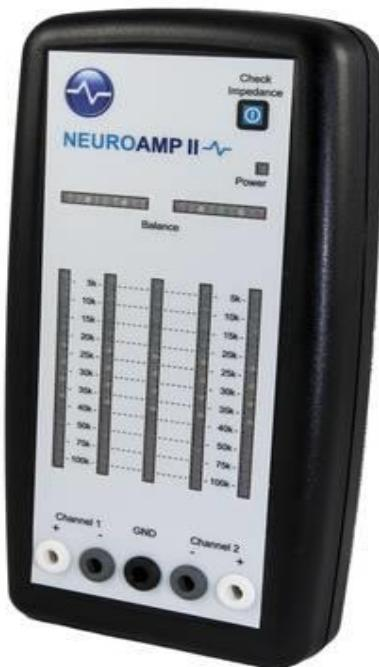
Uloga razlikovnog pojačivača jest u računaju razlika između dva signala, a taj proces je nužan kako bi se odvojili EEG signali od signala iz drugih dijelova tijela ili od električnih uređaja iz okoline. Razlikovni signal snimljen u obliku moždanog vala između dvije elektrode
