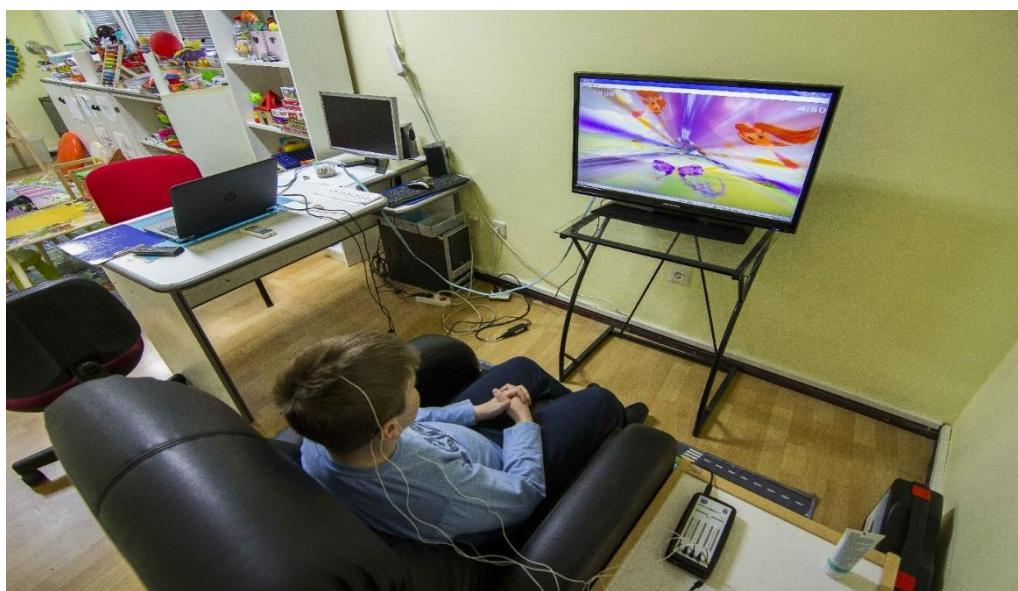
Na slikama 7. i 8. također je prikazana oprema potrebna za neurofeedback koja se sastoji se od NeuroAmp uređaja (amplifier), elektroda i gela za čišćenje površine kože na koju se lijepe elektrode. Ostatak opreme čini prijenosno računalo koje obrađuje podatke i daje povratne informacije preko televizora. Dječak na slikama sjedi u udobnoj fotelji igrajući igru InnerTube.
