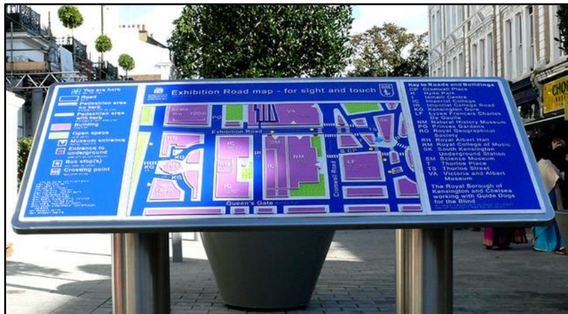
Slika 25. Primjer taktilne mape prostora; isticanje bojama omogućava korištenje od strane slabovidnih osoba
