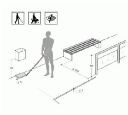
Slika 4. Primjer javne pješačke površine prema odredbama Pravilnika (NN, 151/05)
