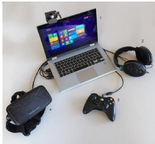
*Slika 20 Oprema korištena u istraživanju Newbutta i sur (2016). Brojevima od 1 do 4 redom su označeni: 1 – prijenosno računalo, 2 – slušalice, 3 - Xbox 360 TM kontroler, 4 – Oculus Rift HMD naočale*
