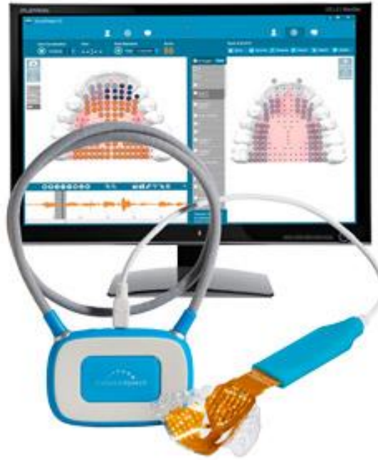
Slika 10. Pametno nepce 'Smart palate' uređaj i računalni prikaz (preuzeto sa http://completespeech.com/smartpalate/ )
