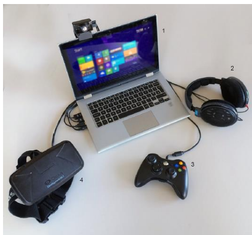
Slika 20 Oprema korištena u istraživanju Newbutta i sur (2016). Brojevima od 1 do 4 redom su označeni: 1 – prijenosno računalo, 2 – slušalice, 3 - Xbox 360 TM kontroler, 4 – Oculus Rift HMD naočale
