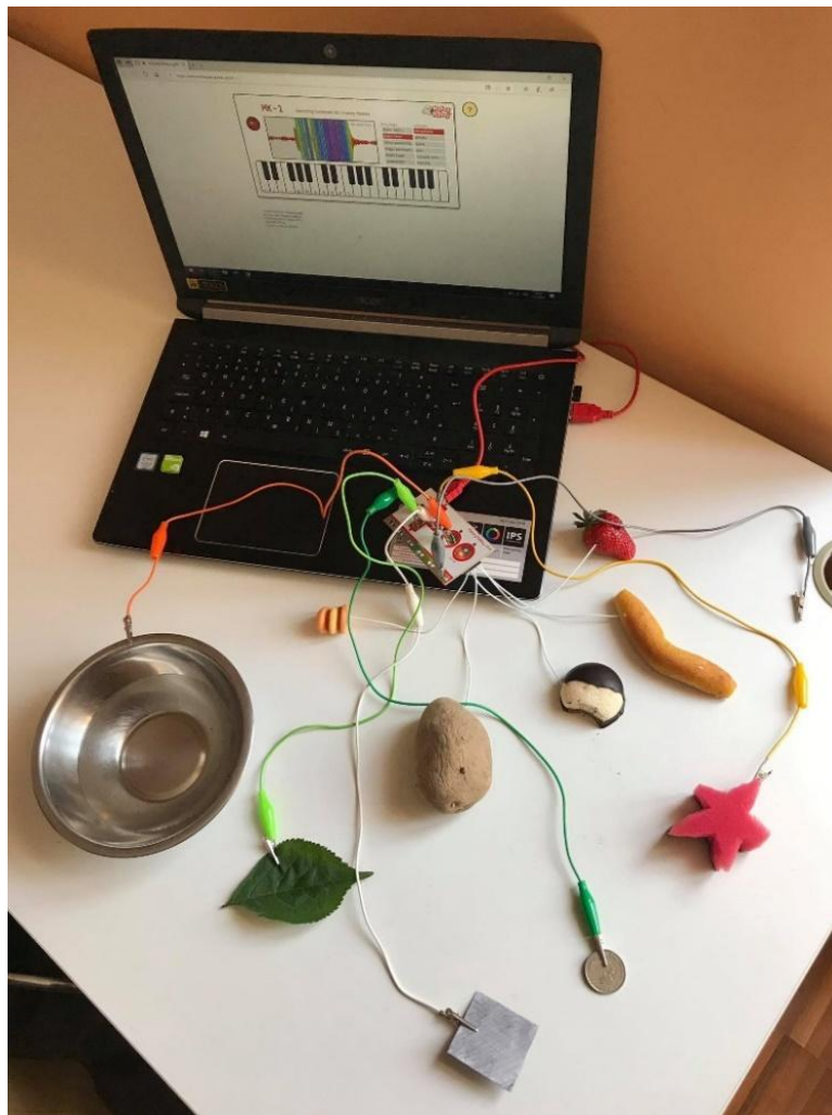
Slika 3 Uređaj Makey Makey i provodljivi predmeti (dizajn autorice)
