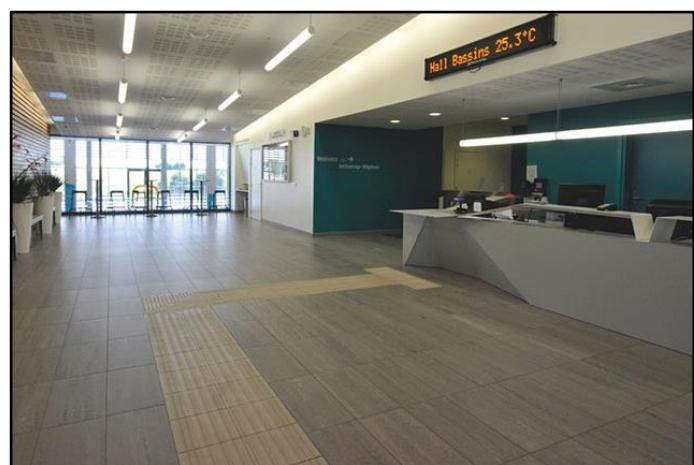
Slika 27. Primjer taktične crte vodilje u unutarnjem prostoru
