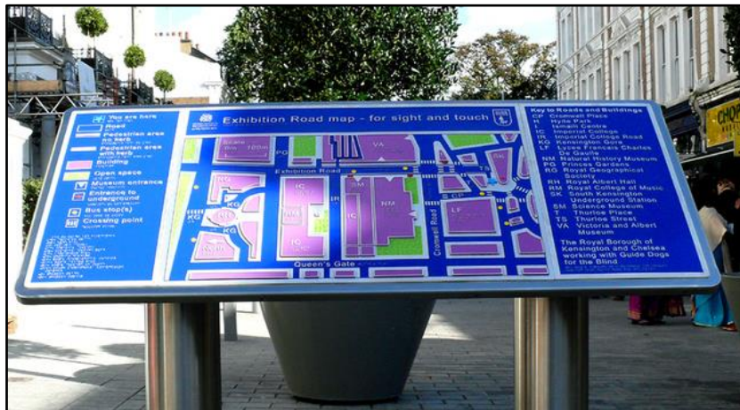
Slika 25. Primjer taktilne mape prostora; isticjanje bojama omogućava korištenje od strane slabovidnih osoba
