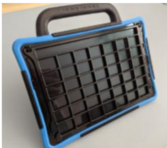
Slika 7 Primjer zaštite za tipkovnicu (eng. keyguard) koja se pričvršćuje na zaslon AAK uređaja (preuzeto iz PRC-Salttillo, 2021)
