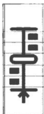
Slika 6. Primjer taktilnog plana pješačkog prijelaza
