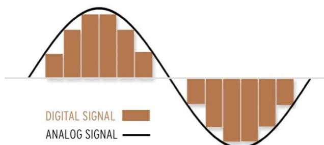
**Slika 1:** Analogni i digitalni signal (Preuzeto iz Gans, 2015).
