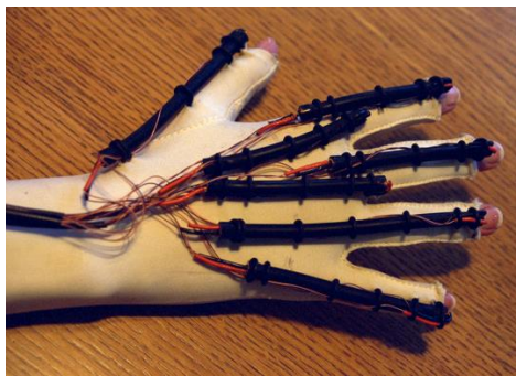
Slika 11 Prve žičane rukavice (dataglove)
