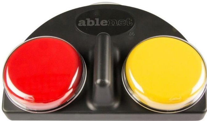
Slika 3. iTalk2 komunikator: sklopka koja se koristila u radu s dječakom
